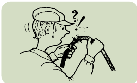
Tarkasta nostovälineiden kunto säännöllisesti.
