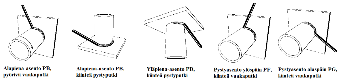
Kuva 3. Piena-asennot putken hitsauksessa [3].
